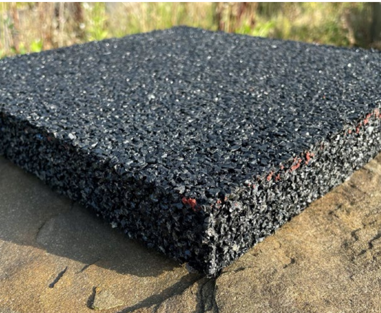
Couche de base – SBR 1-4 mm lié avec le liant Polytech QS30 (avec 3 % p/p d'activateur)
